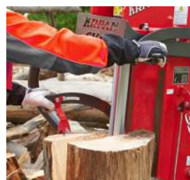
Dvoročni vklop z integriranim držalom za les (leva ročica)
