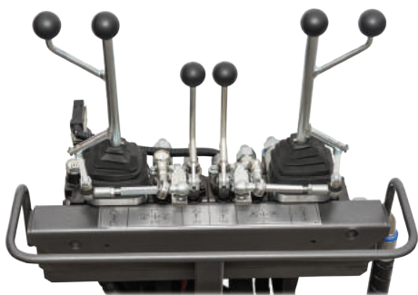
Proporcionalni hidravlično (nizkotlačno) krmiljeni Joysticki
