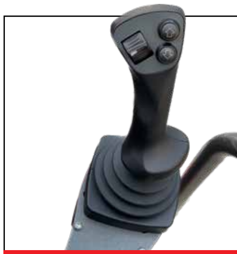
Upravljanje dvigala – hidravlično (nizkotlačno) ali električno upravljanje
